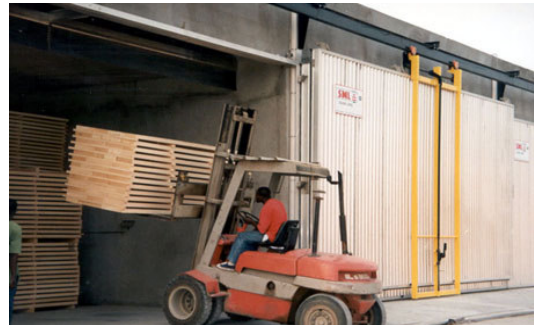
Figura 05: Secador convencional sendo carregado por empilhadeira
